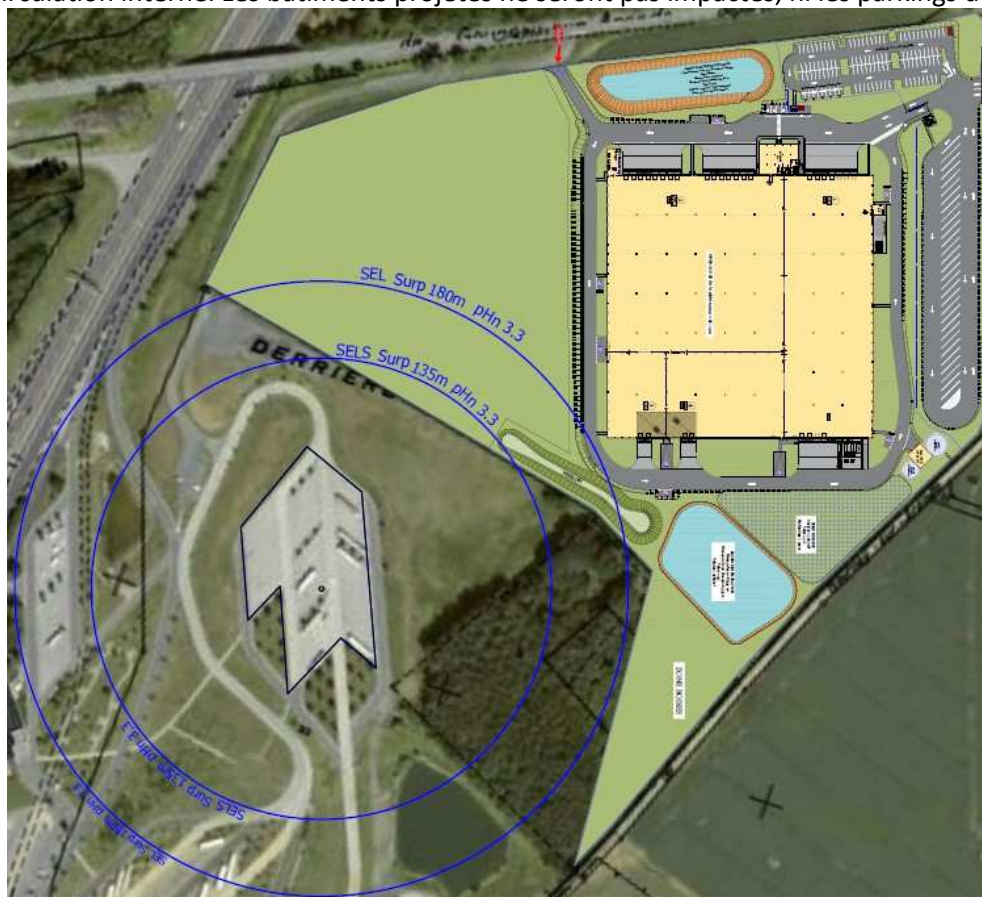
Figure 39 : Effets de surpression en cas de VCE lié à la rupture totale d'une citerne sur le parking de la SANEF
